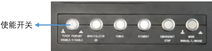
图 7-6 示教器使能开关位置
