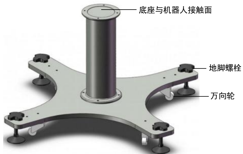
图 6-3 底座结构示意图
