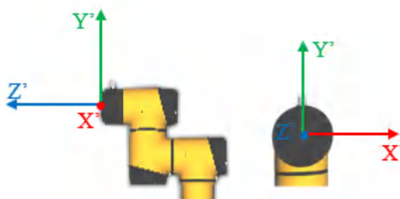
图 10-12 末端坐标系(flange_center)
