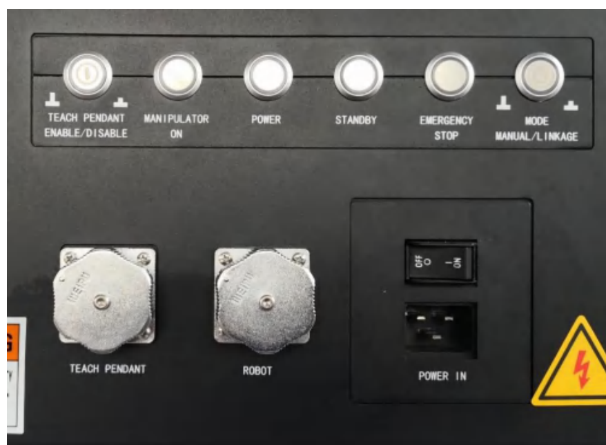
图 7-2 控制柜前面板示意图
