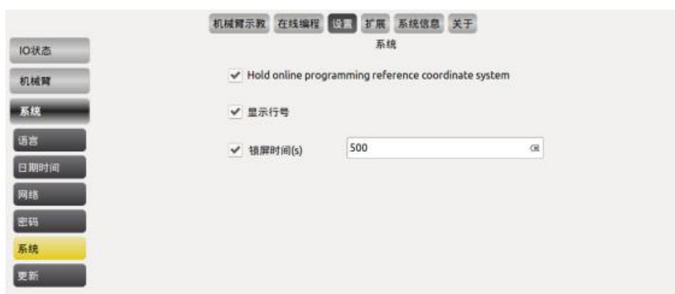
图 10-55 坐标系保持、行号显示与锁屏时间设置
