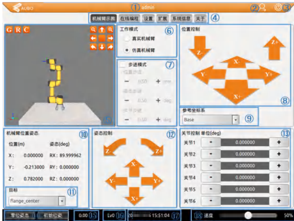
图 10-4 机器人示教面板示意图
