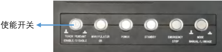
图 7-6 示教器使能开关位置
