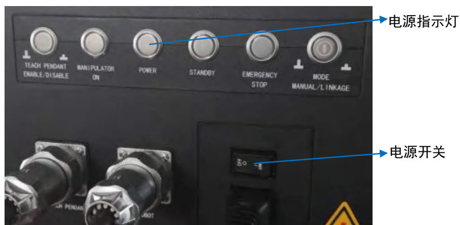
图 9-1 控制柜电源开关及指示灯示意图
