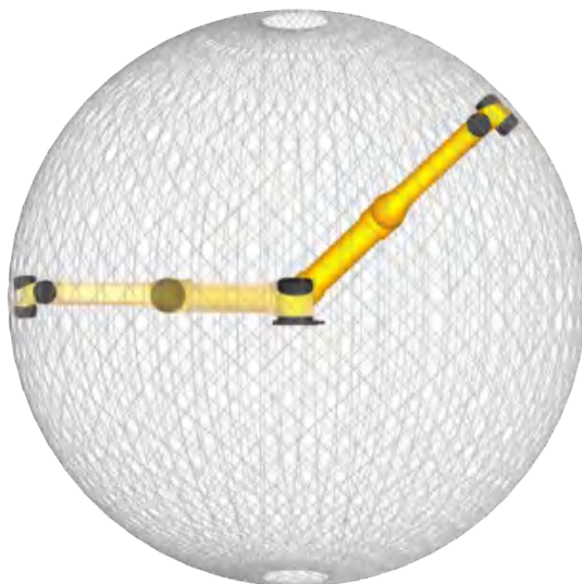
图 6-2 机器人工作空间示意图
