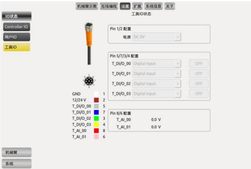
图 10-26 工具端 I/O 设置
