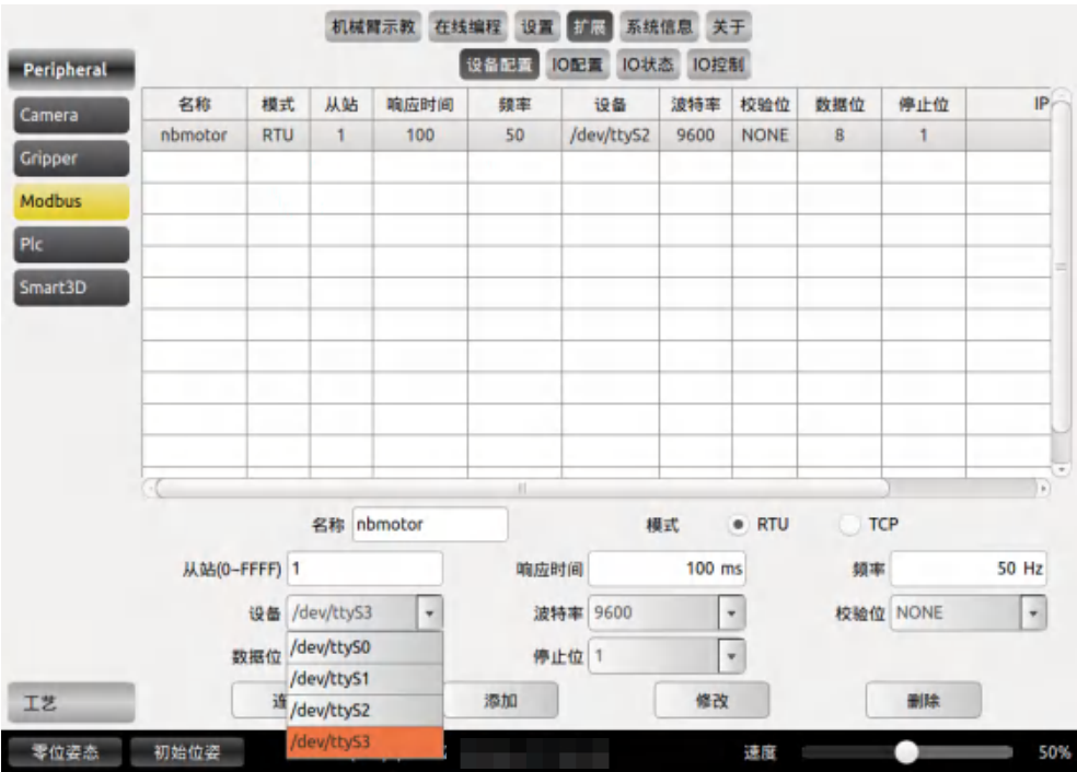
图 10-59 Modbus 设备配置
