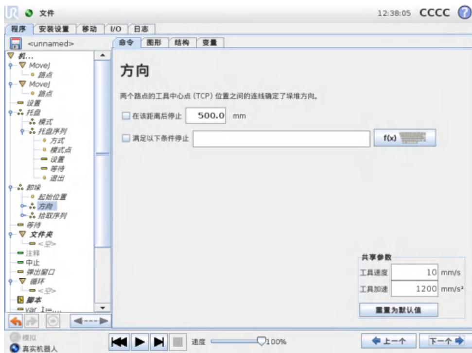
方向由两个位置确定，通过第一个位置 TCP 到第二个位置 TCP 之间的位置差来计算。注意：方向不考虑点的朝向。
