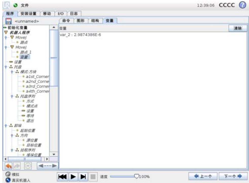
“变量”选项卡显示程序运行中的实时变量值，并在程序运行之间保存传递变量和变量值列表。它仅在有关信息要显示时出现。变量按其名称的字母顺序排列。此屏幕上的变量名最多以 50 个字符显示，变量值最多以 500 个字符显示。
