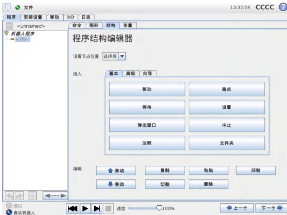
使用程序结构选项卡可以插入、移动、复制和移除各种命令。
