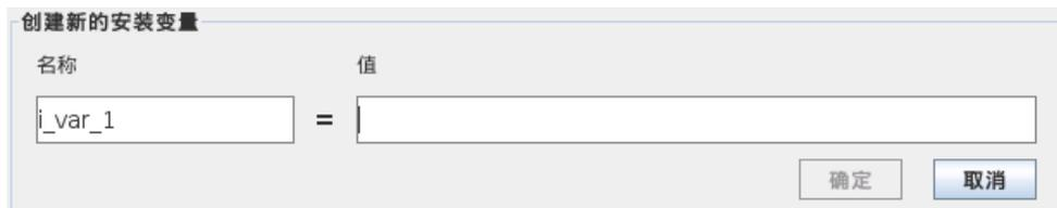
按新建，板上将出现含有新变量建议的名称。该变量名称可以更改，变量值可以通过触摸文本字段输入。只有在这个新名称在该安装设置没有使用的情况下，才可以点击 OK-按钮。
