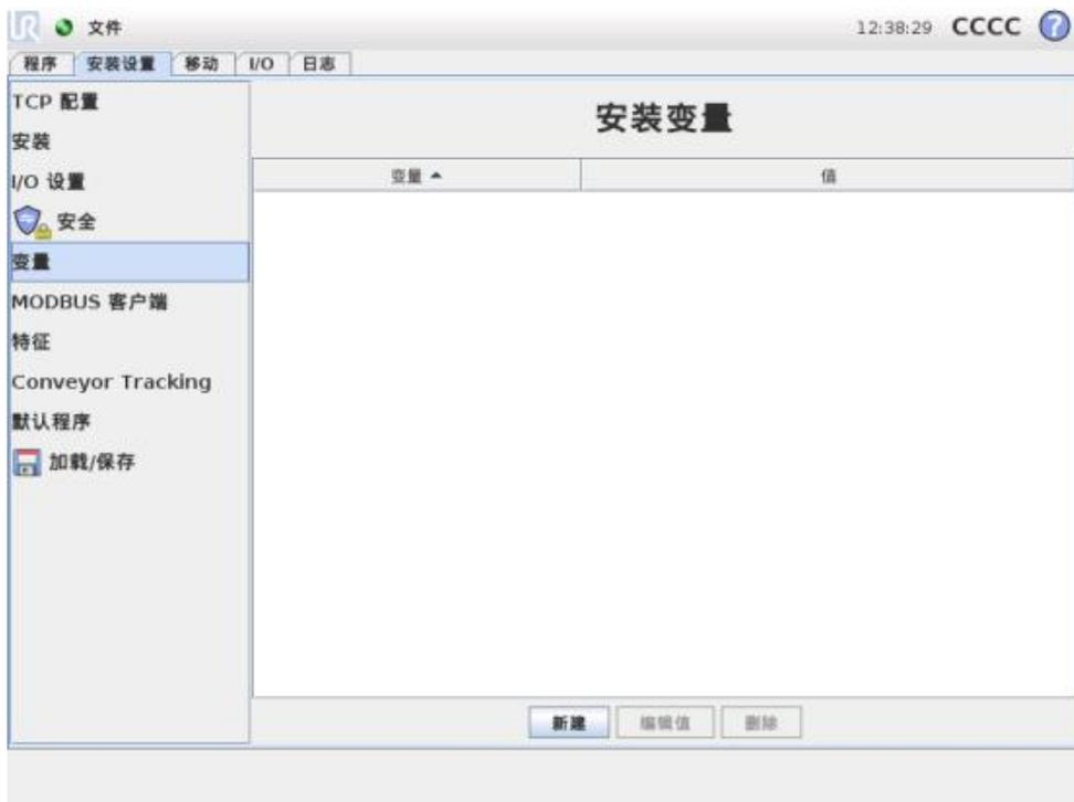
此处创建的变量称为安装设置变量，可以像一般的程序辩论一样使用。安装设置变量非常特殊，因为即使当程序被中断而后再重新启动，以及当机器人手臂和/或控制箱断电而后再重新上电，它们的值依然保留着。它们的名称和值都储存在安装设置中，因此可以在多个程序中使用相同的变量。
