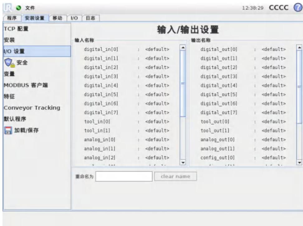
可为输入和输出信号指定名称。这样更便于记住操作机器人时信号的作用。单击选择相应的 I/O 并使用屏幕键盘设置信号名称。通过将名称设置为空字符串，可以还原名称。
