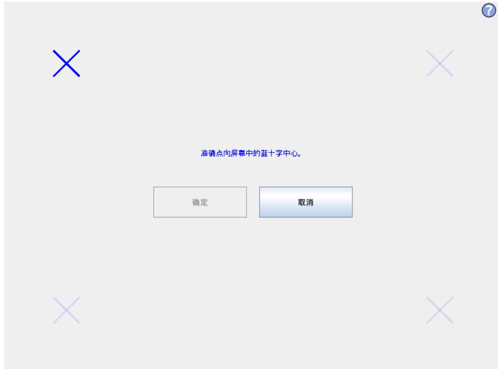
校准触摸屏。按照屏幕说明校准触摸屏。最好使用尖细的非金属物体，例如盖好盖的笔。校准时要仔细耐心，这样有助于获得更好的效果。
