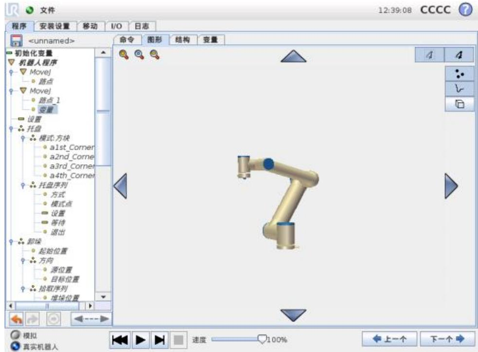
当前机器人程序的图形化表示形式。TCP 的路径以 3D 视角显示，运动段显示为黑色，交融段（运动段之间的过渡）显示为绿色。绿点标明程序中各路点处的 TCP 位置。机器人手臂 3D 图显示机器人手臂的当前位置，机器人手臂“阴影部分”显示机器人手臂到达屏幕左侧所选路点的方式。
