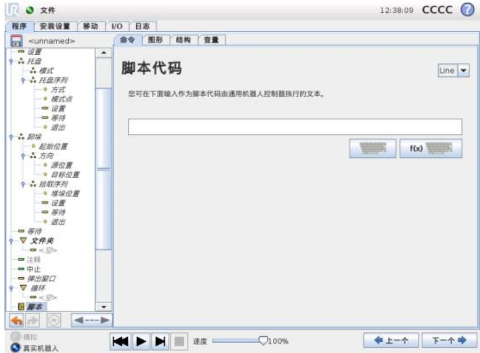
使用此命令可访问由机器人控制器执行的底层实时脚本语言。这是专门针对高级用户的，使用指南可以在支持网站上的脚本手册中找到。(http://support.universal-robots.com/) 注意，只有 UR 分销商和 OEM 客户能够访问该网站。
