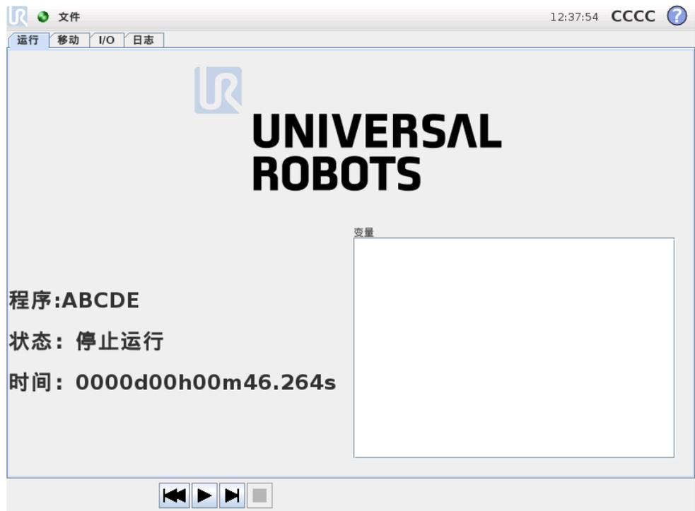
此选项卡提供了一种非常简便的机器人手臂和控制箱操作方法，使用尽可能少的几个按钮和选项即可完成操作，再结合对 PolyScope 编程部分的密码保护功能（请参见 14.3），使机器人成为可以独占运行预先编好的程序的一种工具，这样更为实用。
