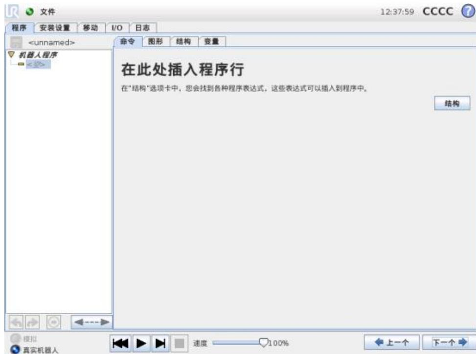
“程序”命令需从此处插入。按结构按钮转至“结构”选项卡，在此选项卡中可找到各种可选用的程序行。指定并定义所有程序行后，程序方可运行。
