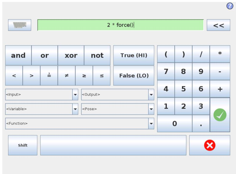
表达式本身可以文本形式进行编辑，同时，也可使用表达式编辑器进行编辑。表达式编辑器提供许多按钮和函数，可用于插入特殊表达式符号，例如表示相乘的 \* 符
