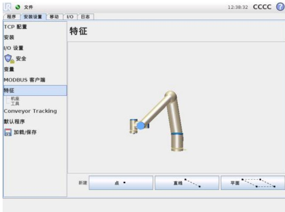
购买工业机器人的客户通常都希望能够相对于机器人手臂周边各种物体和边界 (例如机器、工件或坯料、夹具、输送机、托盘或观察系统)，来控制或操作机器人手臂以及对机器人手臂进行编程。传统的实现方式是定义“框架” (坐标系)，将机器人手臂内部坐标系 (机座坐标系) 和相关对象的坐标系相关联。机器人的内部坐标可根据机器人的“工具坐标”和“机座坐标”来确定。
