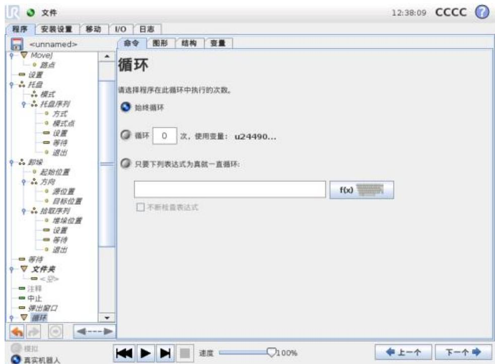
循环运行基本程序命令。基本程序命令可以无限循环运行，也可以运行指定次数，或者只要给定条件为真，即持续运行，具体取决于所做选择。循环运行指定次数时，程序将创建一个专用循环变量（即上面截屏中所谓的 loop\_1），此变量可在循环内部的表达式中使用。循环变量从 0 开始计数，直至  $N - 1$ 。
