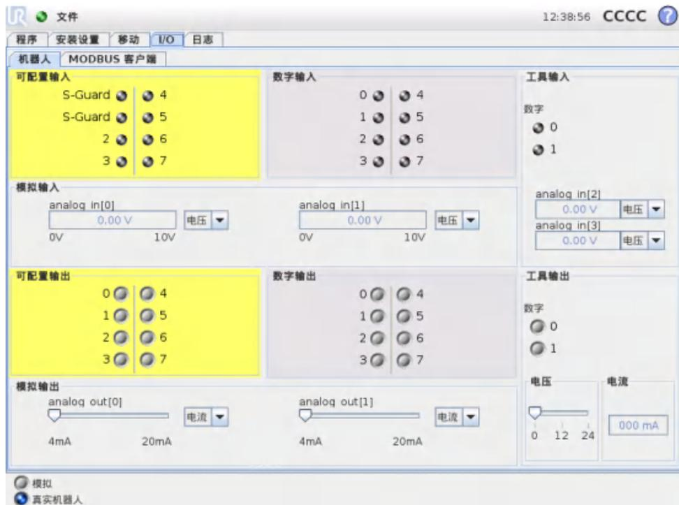
在此屏幕，您可始终监控并设置机器人控制箱收发的实时 I/O 信号。屏幕将显示 I/O 的当前状态，包括程序运行期间的 I/O 状态。程序运行期间如有任何更改，程序将停止运行。程序停止运行时，所有输出信号将保持其状态。屏幕的更新频率为 10Hz，因此，特别快的信号可能无法正确显示。
