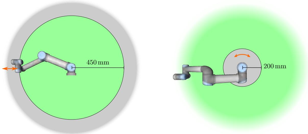
图 5.1: 鉴于机器人手臂的物理性质, 在工作区的某些区域应留意夹伤风险。其中一个区域是定义的径向运动区域, 即手腕 1 关节至少与机器人底座相距 450 mm 的区域。另一个区域是在机器人底座 200 mm 范围内的区域 (机器人按正切方向移动时)。
