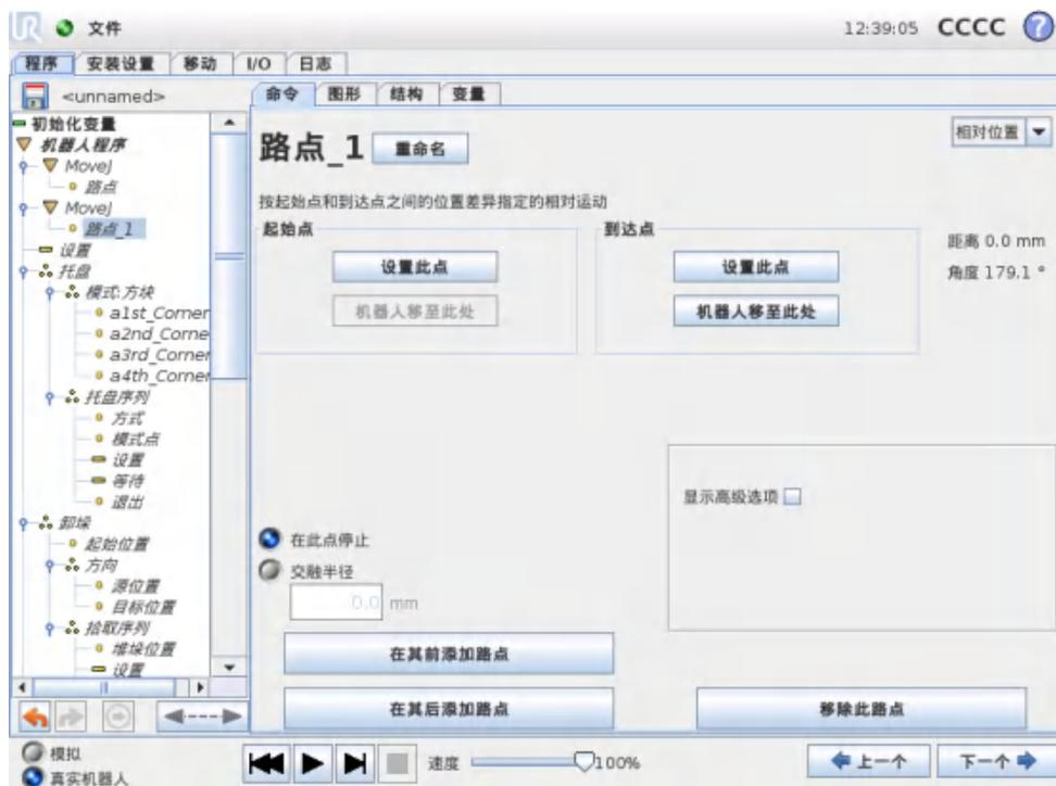
相对路点系指该路点的位置是以相对于机器人手臂上一个位置的位置差的方式给出的，例如“偏左两厘米”。相对位置是根据两个给定位置（从左至右）之间的差距而定义。请注意，重复的相对位置可能会将机器人手臂移出其工作空间。
