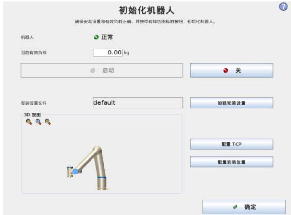
在此屏幕上，您可以控制机器人手臂的初始化。
