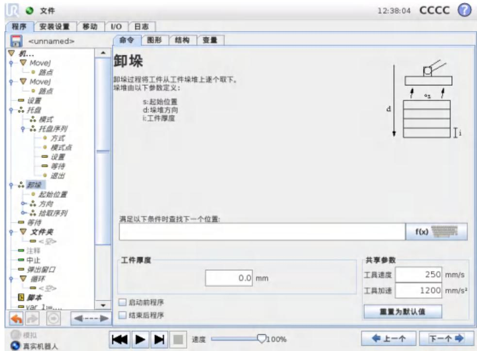
卸垛时，机器人手臂从起始位置沿着指定方向移动，搜索下一工件。屏幕上的条件决定何时到达下一工件。当条件满足时，机器人将记住此位置并执行特定序列。在下一轮，机器人将从所记住的位置开始以工件厚度为增量沿着卸垛方向搜索。
