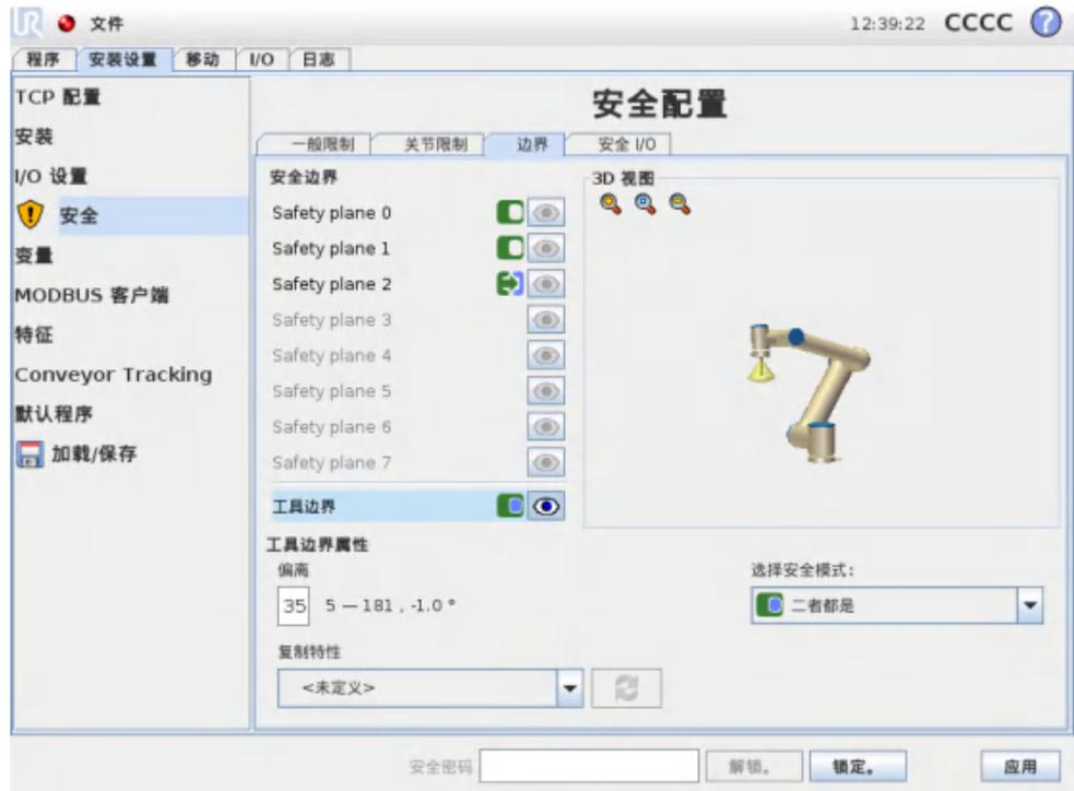
位于选项卡底部的工具边界属性面板定义了机器人工具方向的限度，该限度由理想的工具方向和该方向的最大允许偏离值组成。
