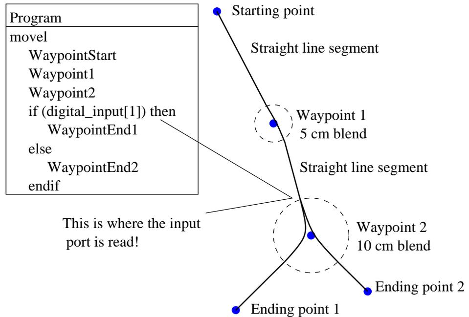
上图示例中，机器人程序将工具从起始位置移至两个终点位置之一，具体移到哪个位置取决于 digital\_input[1] 的状态。请注意，在交融区域（虚线圆圈）之外，工具轨迹（粗黑线段）是以直线运动，而在混合区域以内，工具轨迹则会偏离直线路径。另请注意，程序恰好是在机器人手臂将要进入路点 2 的混合区域时读取 digital\_input[1] 传感器的状态，即便程序序列中的 if...then 命令是位于路点 2 之后。这似乎与我们的直觉判断相违，但必须选择正确的交融路径。
