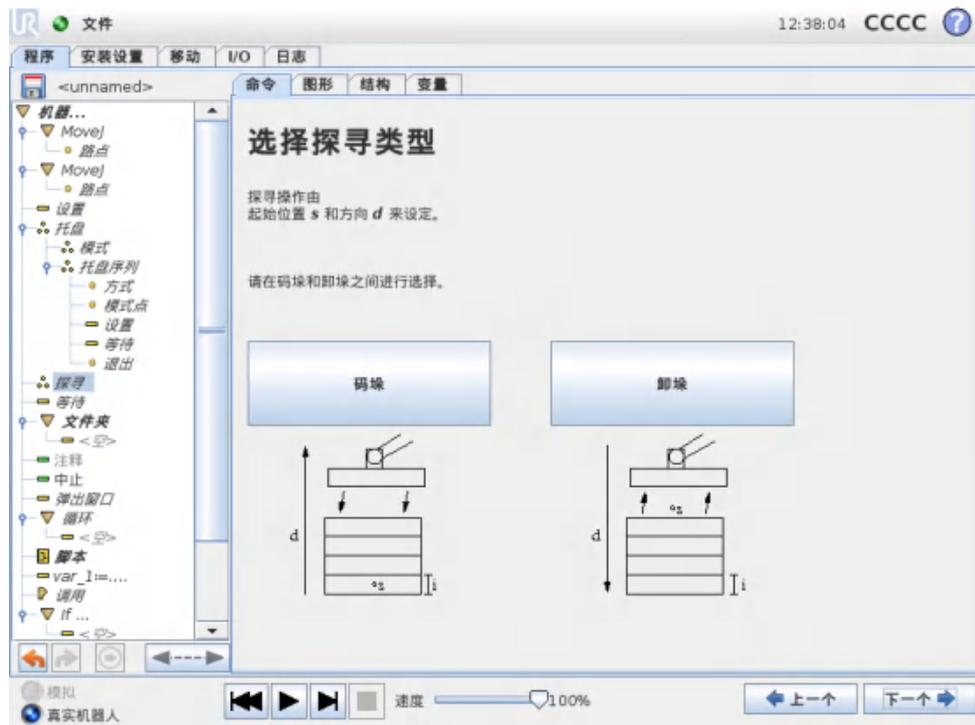
码垛时，机器人手臂将移至起始位置，然后反向移动以搜索下一个堆垛位置。找到下一个堆垛位置时，机器人将记住此位置并执行特定序列。在下一轮，机器人将从所记住的位置开始以工件厚度为增量沿着码垛方向搜索。当码垛高度超出所定义的数值时，或者传感器发送信号时，码垛操作即告完成。
