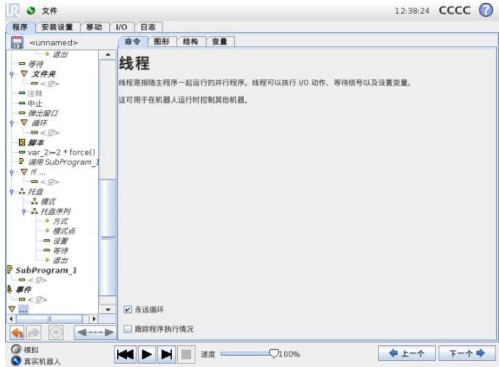
线程是机器人程序的一个并行进程。线程可用于控制与机器人手臂无关的外部机器。线程可以通过变量和输出信号和机器人程序进行通信。
