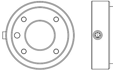
此连接器为特定机器人工具上使用的夹持器和传感器提供电源和控制信号。适合使用的工业电缆如下：
