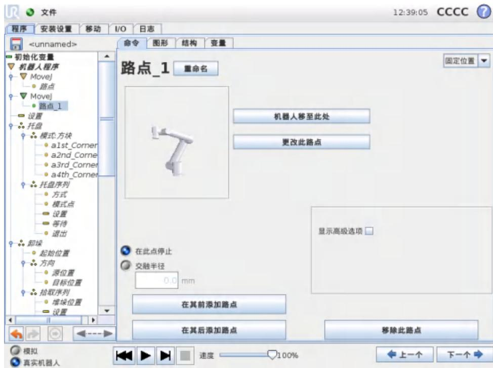
机器人路径上的点。路点是机器人程序的核心要素，指示机器人手臂移动到哪个位置。固定位置路点通过将机器人手臂实际移至相应位置来确定。
