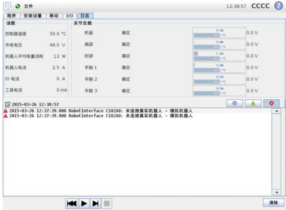
**机器人状况** 屏幕上半部分显示机器人手臂和控制箱状况。左侧显示机器人控制箱的相关信息，右侧显示机器人每个关节的相关信息。机器人每个关节相关信息包括电机和电子设备的温度、关节负载以及关节处的电压。
