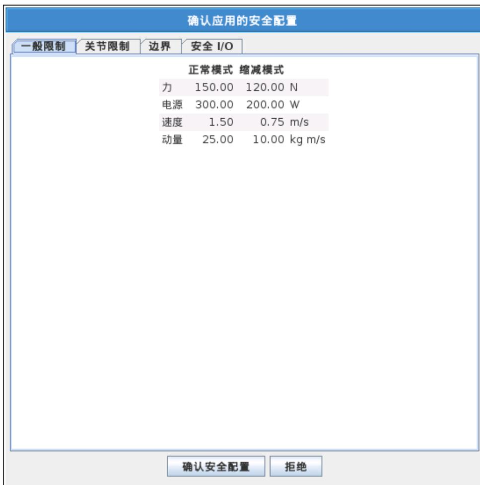
此外，通过确认，这些更改将被自动保存在当前机器人安装中。请参阅 12.5 了解保存机器人安装的更多信息。
