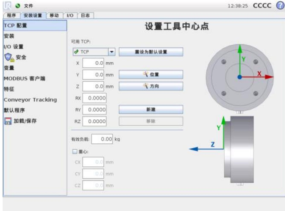
工具中心点 (TCP) 既机器人工具的特征点。多个指定的 TCP 可在此屏幕上定义。每个 TCP 都包含相对于工具输出法兰中心而设定的转换和旋转，如屏幕上的图形所示。位置坐标 X、Y 和 Z 决定了 TCP 的位置，而 RX、RY 和 RZ 决定了其方向。当指定的值均为零时，TCP 与工具输出法兰的中心点重合，并应用屏幕右侧显示的坐标体系。
