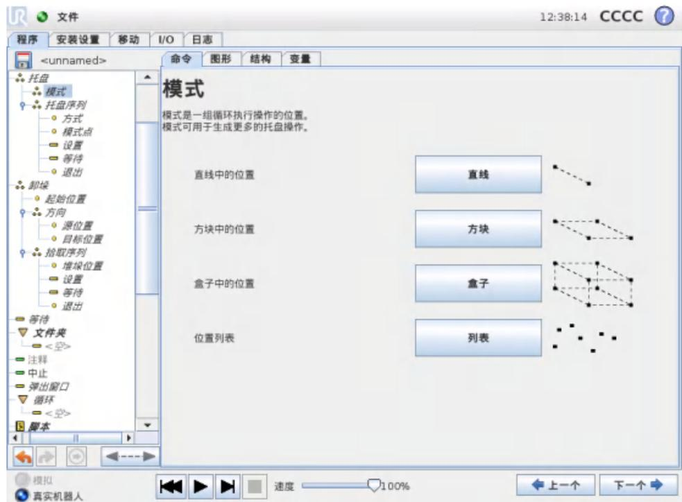
“模式”命令可用于在机器人程序中指示机器人循环通过各个位置。每次执行“模式”命令时，其均与一个位置相对应。
