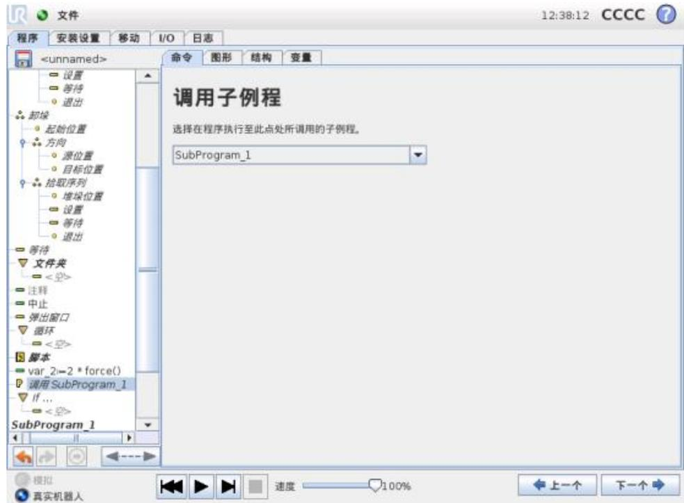
调用子程序时将运行子程序中的程序行，运行完子程序中的程序行后再返回到程序的下一行继续运行。
