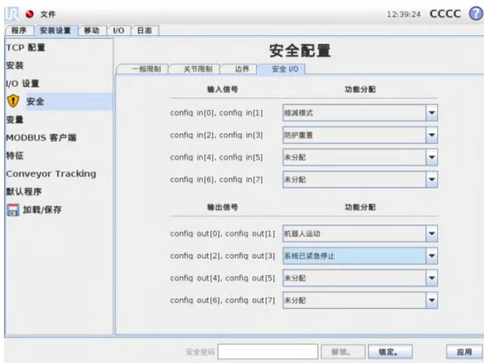
此屏幕定义了可配置输入和输出 (I/O) 的安全功能。I/O 分输入输出，并且成对出现，这样每个功能都有一个 3 类和 PLd I/O，以确保安全（比如某个 I/O 不稳定的情况下）。
