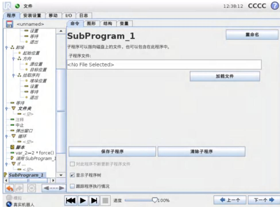
“子程序”命令可以将所需的程序部分存放在多个位置。子程序可以是磁盘上的独立文件，也可以隐藏以免被意外修改。
