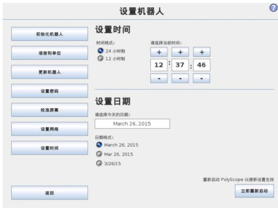
设置系统的时间和日期，并配置时钟的显示格式。时钟显示在运行程序和机器人编程屏幕顶部。轻触时钟将立即显示日期。必须重新启动 GUI，所做更改方可生效。
