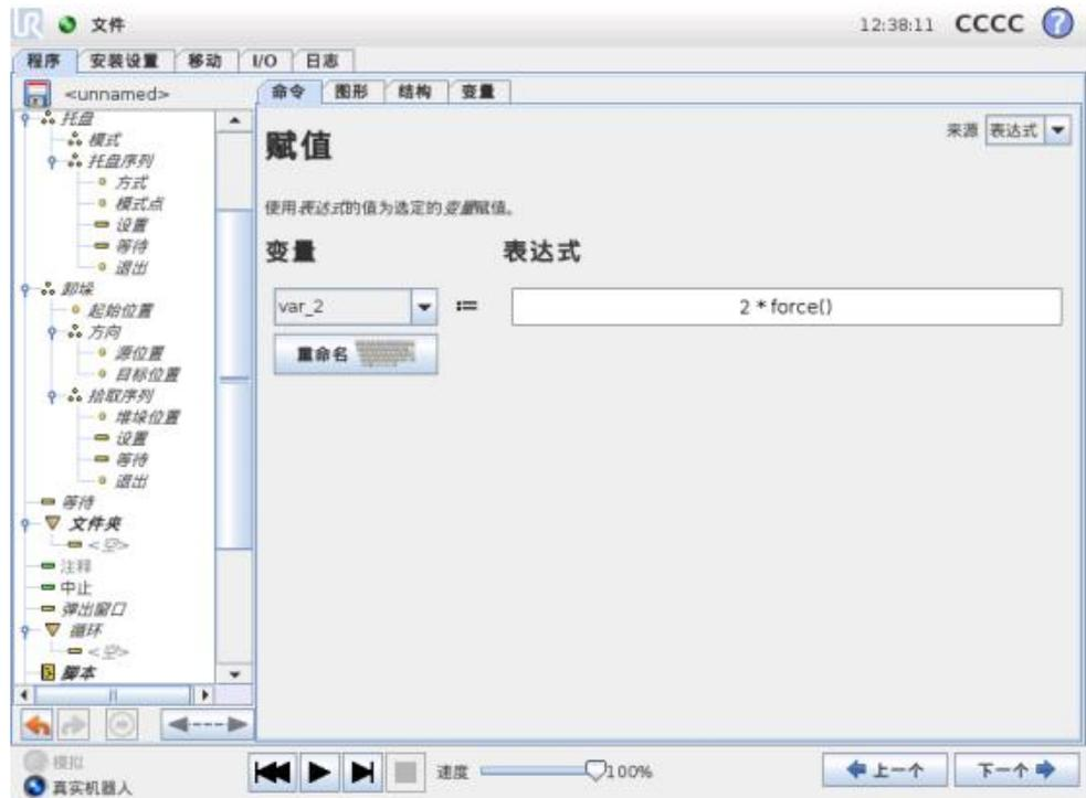
为变量赋值。通过赋值可将右侧的计算值赋给左侧的变量。此命令在复杂程序中很实用。
