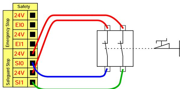
此配置仅针对操作员不能通过门并在身后关上门的应用。可配置的 I/O 可以用于设置门外的重置按钮，以重新激活机器人运动。
