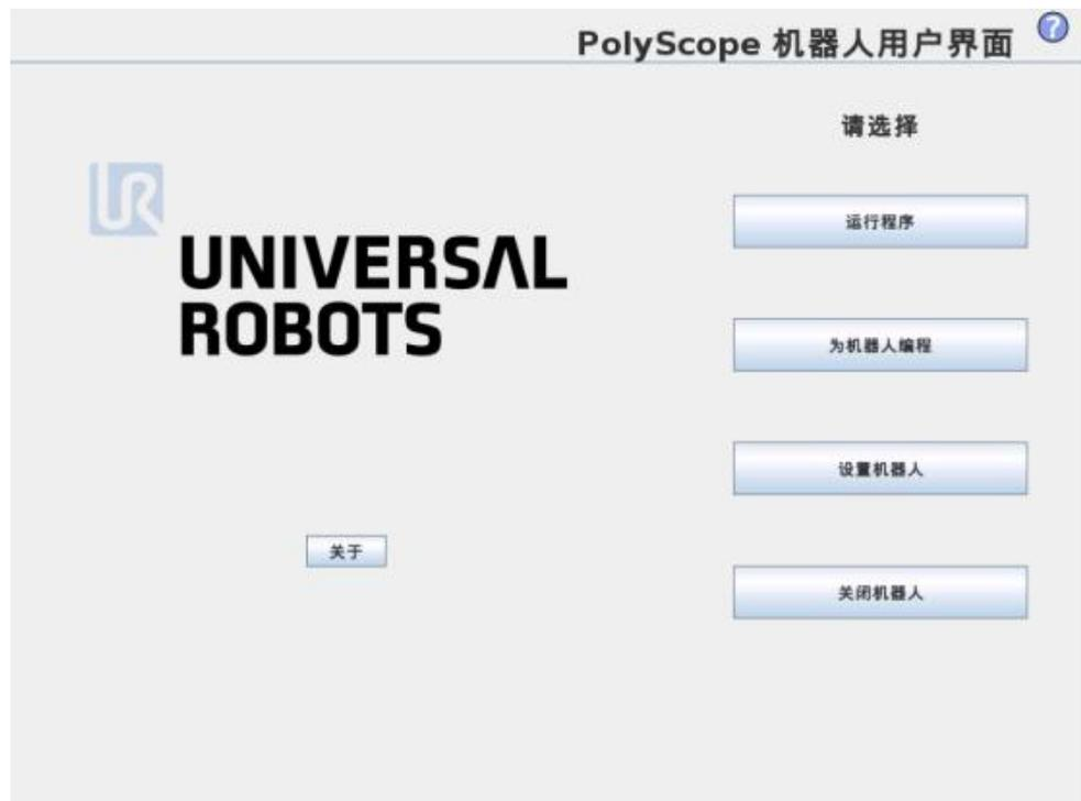
上图显示的是“欢迎”屏幕。屏幕浅蓝区域的按钮可通过手指触摸或笔端触碰来操作。PolyScope 以层级结构的形式来组织各个屏幕画面。在编程环境中，屏幕以选项卡的形式组织排列以便于访问。
