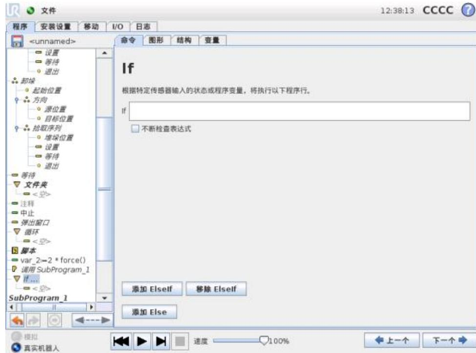
“if...else”结构可以指示机器人根据传感器输入或变量值来改变其行为。使用表达式编辑器可描述指定机器人继续执行此 If 命令的子命令的条件。如果条件为真，则将执行此 If 命令内部的命令行。
