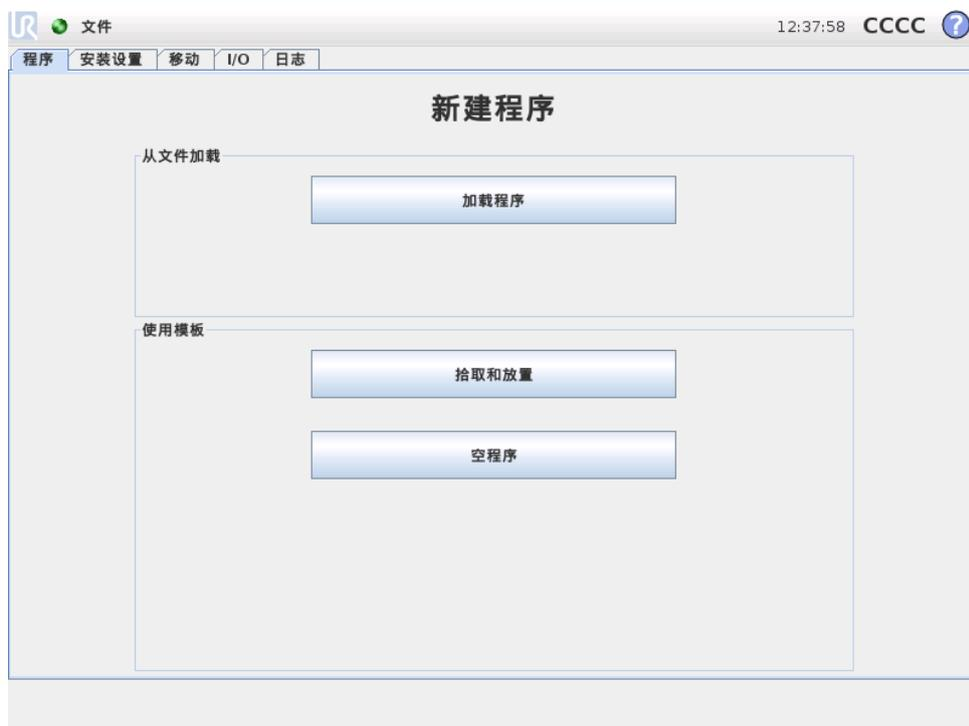
新机器人程序可以通过套用模板或参照现有（已保存）机器人程序来创建。模板提供整个程序结构，只需填写程序的细节内容即可。
