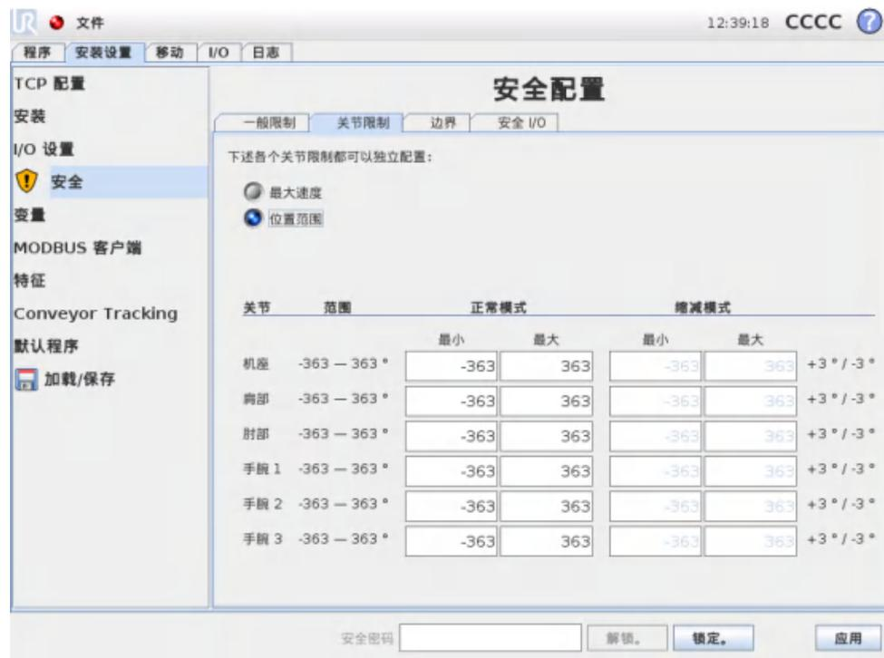
关节限制对每个关节在关节空间的运动进行限制，即关节限制指的不是笛卡尔空间，而是关节内部（旋转）位置和旋转速度。次面板上部的无线电按钮实现了对最大速度和位置范围的独立设置。
