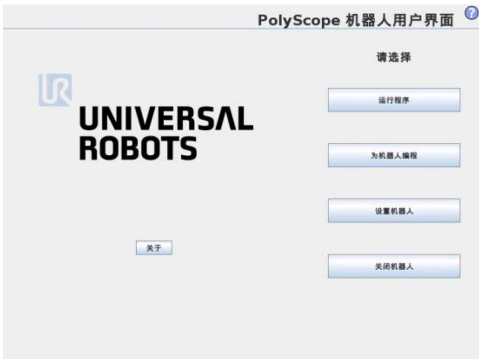
启动控制器 PC 后，将显示欢迎屏幕。此屏幕提供以下选项：
