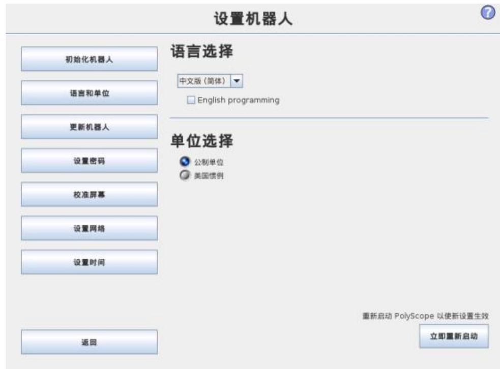
PolyScope 中使用的语言和单位可以在该屏幕设定。PolyScope 上不同屏幕显示的文本都将以选定的语言显示，内嵌的帮助文件也将以选定的语言显示。勾选“英文编程”，以英文显示机器人程序内的命令名称。PolyScope 必须重新启动，所做更改方可生效。
