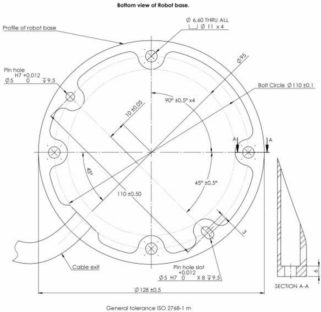
图 3.1: 机器人安装孔。使用 4 颗 M6 螺栓。所有测量值均以 mm 为单位。
