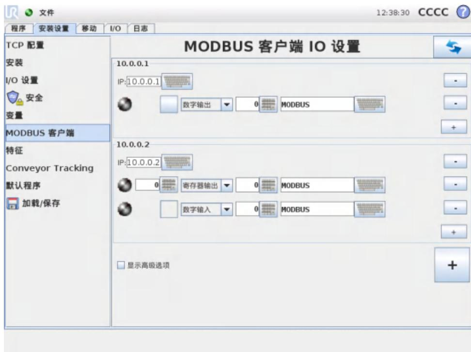
此处可设置 MODBUS 客户端（主机）信号。可由输入/输出信号（寄存器或数字）创建与指定 IP 地址的 MODBUS 服务器（或从设备）的连接。每个信号都有唯一的名称，因此可用在程序中。
