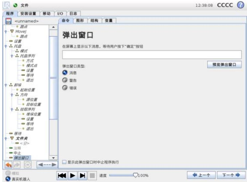
利用“弹出窗口”命令可指定一则消息，程序运行至此命令时在屏幕上显示该消息。您可以选择消息的样式，通过屏幕键盘可输入消息文本。显示弹出窗口后，机器人将等待用户/操作员按下窗口中的“确定”按钮，然后才继续运行程序。如果选中“中止程序执行”，机器人程序将在弹出此消息窗口时中止运行。
