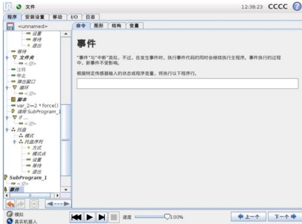
“事件”命令可用于监控输入信号，以及在输入信号呈高电平时执行某个动作或设置变量。例如，当输出信号呈高电平时，事件程序可等待 100ms，然后将其重新设置为低电平。这样，如果外部机器上的触发机制是上升沿而非高输入电平时，主程序代码要简单得多。
