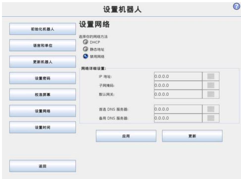
用于设置以太网网络的操作面板。运行基本的机器人功能无需连接以太网，且默认情况下禁用以太网连接。
