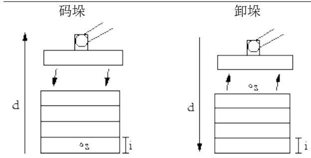
编写用于处理堆垛探寻操作程序时，必须定义  $s$ （起始点）、 $d$ （堆垛方向）和  $i$ （堆垛中的工件厚度）。
