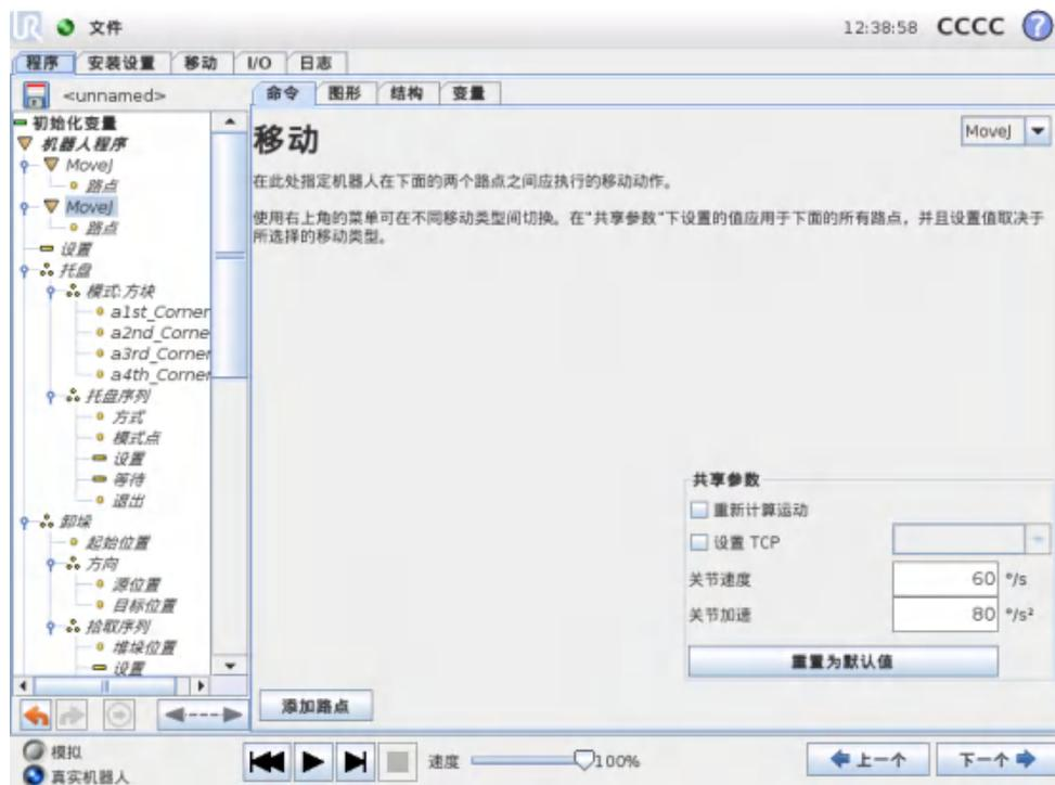
“移动”命令通过基本路点控制机器人的运动。路点必须置于“运动”命令下。“移动”命令定义机器人手臂在这些路点之间的加速度和移动速度。
