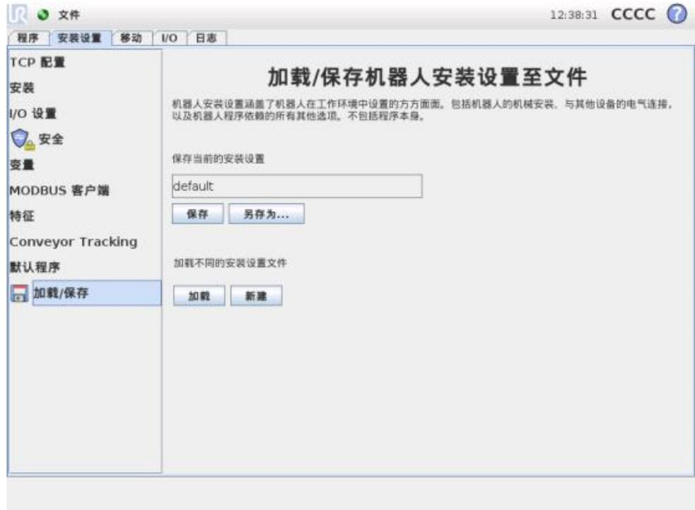
机器人安装设置涵盖了机器人在工作环境中设置的方方面面。包括机器人手臂的机械安装、与其他设备的电气连接，以及机器人程序依赖的所有其他选项。不包括程序本身。
