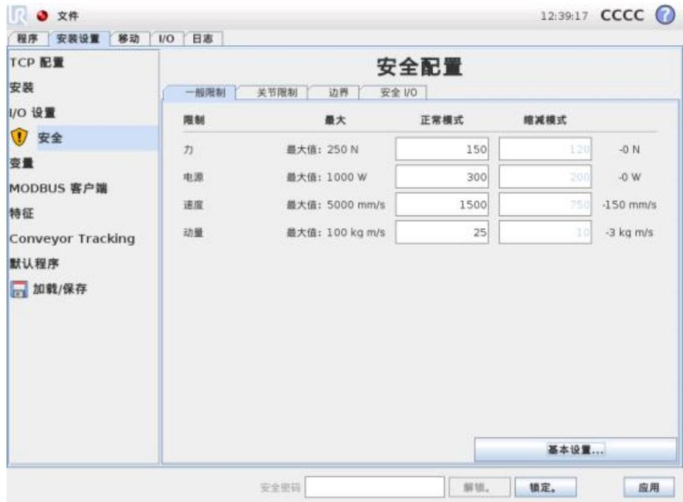
15.9中的每一个一般限制都可以独立设置。方法是点击文本域，然后输入一个新的值。每个限制的最大可接受值列于最大一栏中。力的限制可设置为介于 100 N（UR3 时为 50 N）和 250 N 之间的值，功率限制可设置为介于 80 W 和 1000 W 之间的值。
