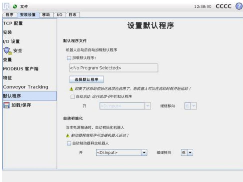
该屏幕包含自动加载设置、启动默认程序，以及在启动时，自动对机器人手臂进行初始化。
