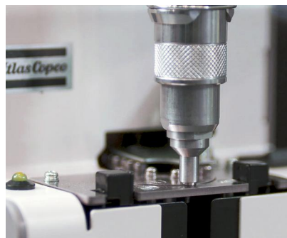
末端执行器利用机器人的灵敏性能顺利对准螺钉进行紧固。
